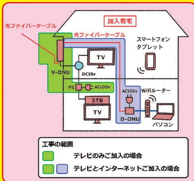
※1 V-ONU (映像用終端装置) …光信号をテレビ信号へ変換する装置
